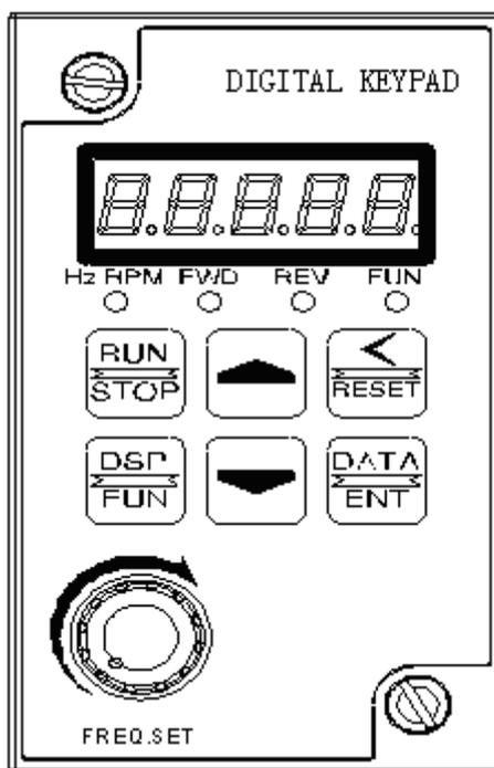
**1.FUN、HZ/RPM** 两种状态指示灯动作，及五位七段显示器的显示内容请参考操作面板使用说明。
